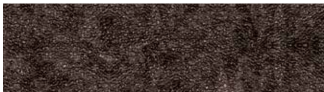
Površina USB Coll Solar BIT iz aluminija ojačanega s poliesternimi nitmi in s površino obdelano proti zdrsu
