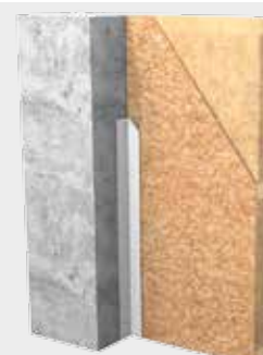
Tesnjenje stika med leseno steno in zidom, ki bo ometan
