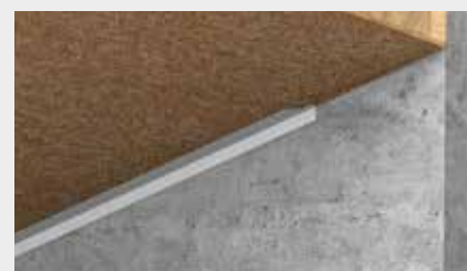
Tesnjenje spoja med lesnim podom in steno, ki bo ometana
