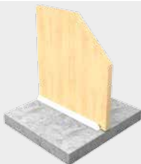
Tesnjenje baze lesenih sten (tako okvirjev kot X-Lam)
